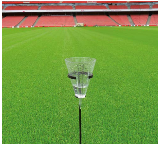
L'utilisation d'un pluviomètre sur le terrain est une des bonnes pratiques pour suivre et bien gérer l'arrosage. ©F. LE ROUX, Sport International
