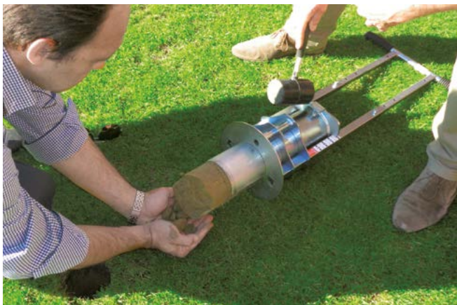
On peut également procéder à l'extraction de carottes simples à l'aide d'un hole-cutter pour limiter les dégâts sur la pelouse. Cela peut s'avérer suffisant si des profils ont précédemment déjà été réalisés. © Sport International
